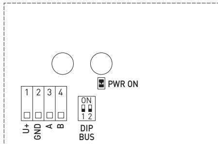
**Borne push-in-****+UB** Borne 1 : + UB 24 V**GND** Borne 2 : -UB GND**A/B** Borne 3/4 : RS485 Modbus**LED d'état****PWR ON** Tension d'alimentation**Commutateur DIP****DIP BUS** Activation ou désactivation
