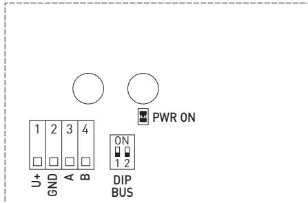
**Push-in-Klemme****+UB** Klemme 1: +UB 24 V**GND** Klemme 2: -UB GND**A/B** Klemme 3/4: RS485 Modbus**Status-LED****PWR ON** Versorgungsspannung**DIP-Schalter****DIP BUS** Aktivierung bzw. Deaktivierung
