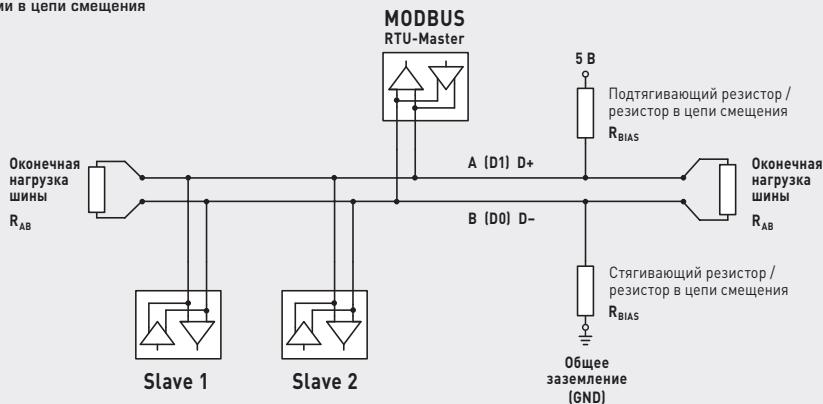
Оконечная нагрузка шины включается и выключается с помощью DIP-переключателя. При этом резисторы смещения, которые отдельно активируются с помощью DIP2, и согласующий резистор включаются или выключаются между обеими линиями передачи данных А и В. При необходимости технического обслуживания можно очень просто проверить различные рабочие сценарии.
