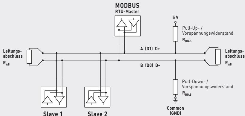
Über DIP-Schalter kann der Busabschluss komplett zu- oder abgeschaltet werden. Dabei werden sowohl die BIAS-Widerstände, die separat über DIP 2 aktiviert werden können, als auch der Leitungsabschluss-Widerstand zwischen den beiden Datenleitungen A und B zu- oder abgeschaltet. Im Servicefall können dadurch auf einfache Weise verschiedene Betriebszonen geprüft werden.
